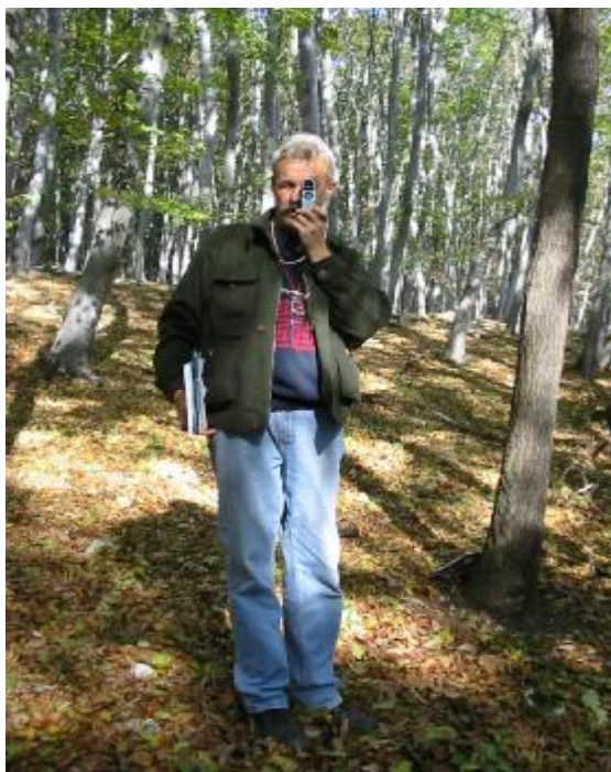
Fűsz Imre erdőtervező körlapmérést végez Bitterlich-féle tükrös relaszkóppal
