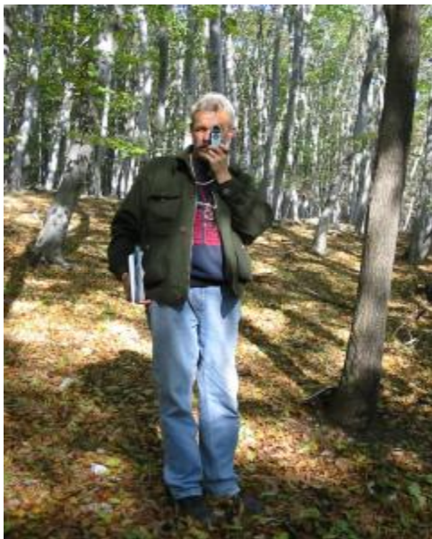
Fűsz Imre erdőtervező körlapmérést végez Bitterlich-féle tükrös relaszkóppal
