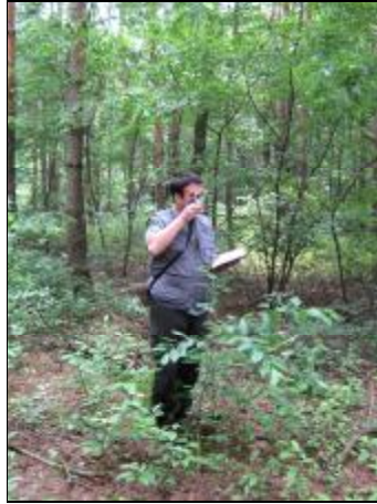
Stuller Zoltán erdőtervező körlapmérést végez Bitterlich-féle tükrös relaszkóppal
